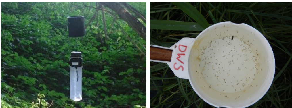
Abbildung 5. Links: CO 2 -Falle zum Fang adulter Stechmücken. Rechts: Schöpfkelle zur Abschätzung der Dichte von Gelsenlarven. Fotos: P. Wenzl (DWS Hydro-Ökologie).
