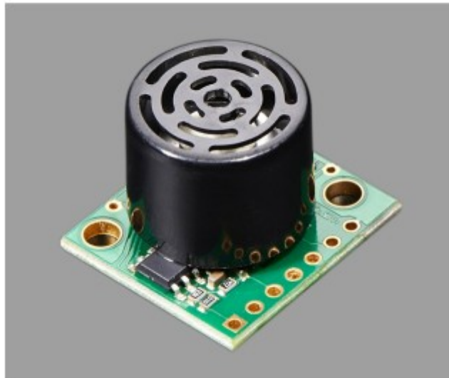
Εικόνα 4.2 Ο αισθητήρας υπερήχων MaxSonar MB1003 εντοπίζει αντικείμενα σε απόσταση ως και 5 μέτρα (Πηγή: Charles Platt and Fredrik Jansson, Encyclopedia of Electronic Components Volume 3)
