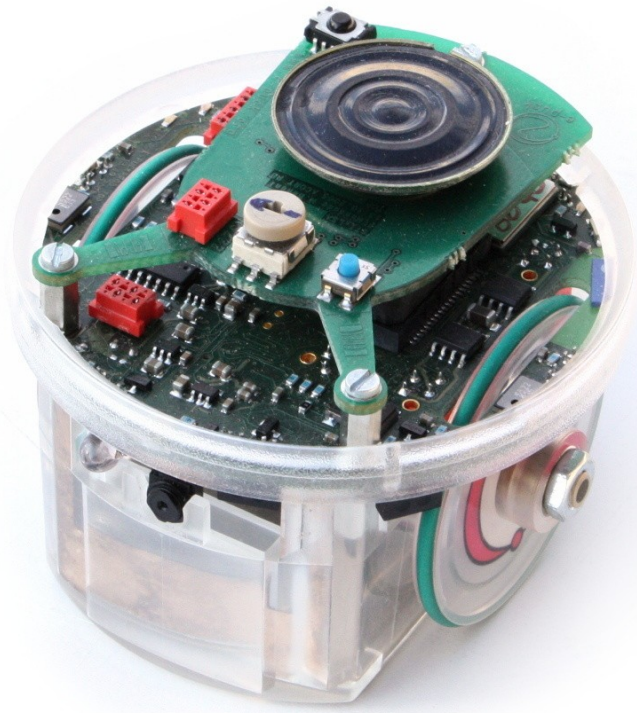
Εικόνα 7.1 Το κινούμενο ρομποτικό όχημα E-ruck
