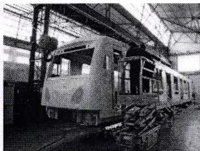
Fotografía 33. Montaje de testero de poliéster en carro.
