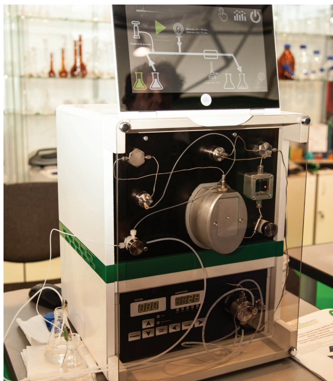
■ Опытный образец гидрогенизационного реактора проточного синтеза
