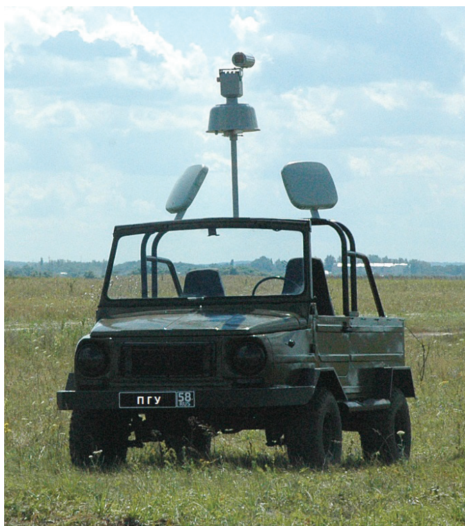
■ Электромобиль с установленной системой Радексан-Антидрон
