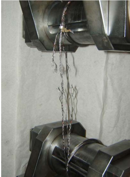
Vue du câble à piquer sur la machine de traction après essai : fort détournement
