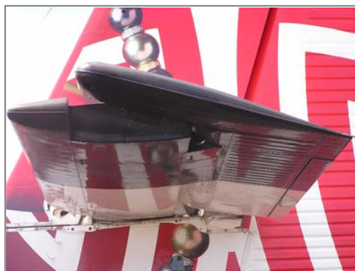
Gouverne de profondeur en position verrouillée
