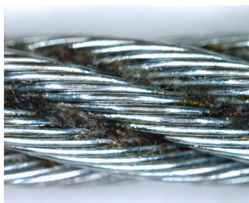
Vue à la loupe binoculaire de la zone de frottement sur un câble en acier au carbone après 150 000 cycles
