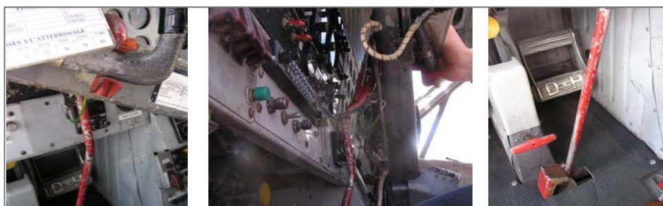
Système de verrouillage des commandes de vol
