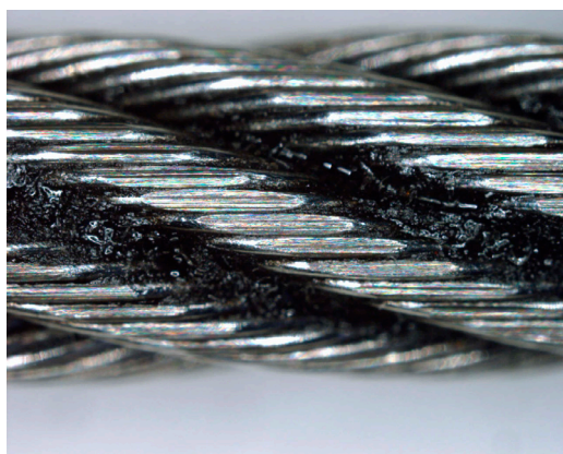
Vue à la loupe binoculaire de la zone de frottement sur un câble en acier inoxydable après 150 000 cycles
