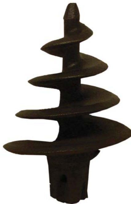
Vite austriaca per l'ancoraggio dei reticolati nel terreno o nel ghiaccio. Tortona, Biblioteca civica.
