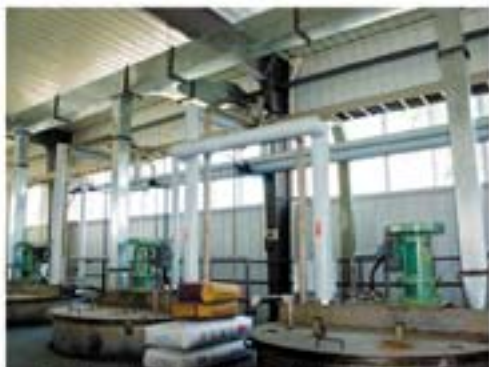
工艺特点：首先生产出粒形和粒径完全不同的D乳剂和L乳剂，再根据需要按一定比例合成乳化沥青。
