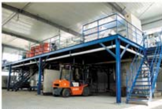
乳化沥青生产线，整体从日本引进。产能5万吨/每年，可满足1千公里CRTS I型板CA砂浆灌注施工。
