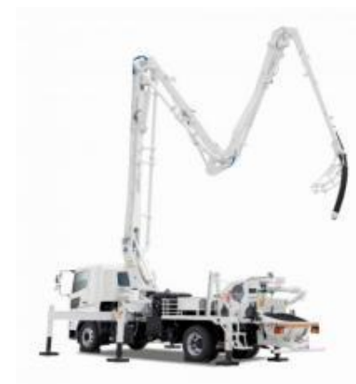
コンクリート ポンプ車
