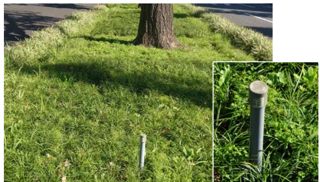
再整備後の地被植物と地下水位観測孔（手前の管）
