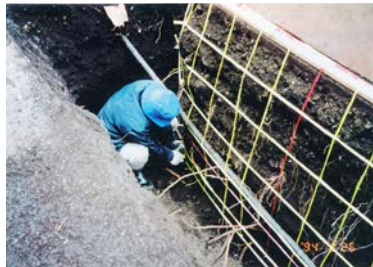
掘削断面による根系調査
