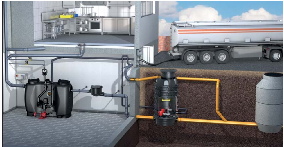
Nachgeschaltete Rückstauhebeanlage Ecolift XL -Duoanlage im Technikmodul zum Erdeinbau hinter einem Fettabscheider NS 4
