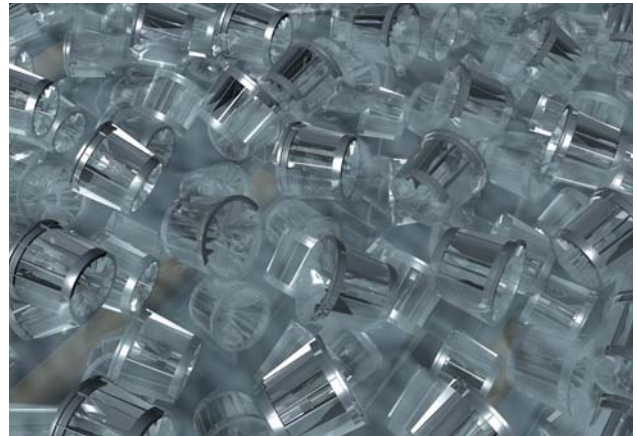
Die KESSEL Füllkörper bilden die Basis für Bifena . Sie bewegen sich frei im Reaktor und bilden die Aufwuchsfläche für die Bifena -Bakterien. Mittels spezieller Belüfterkerzen wird ständig Sauerstoff zugeführt.
