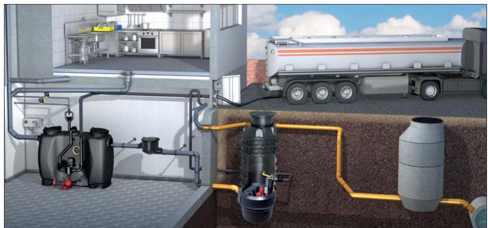
Nachgeschaltete Pumpstation Aqualift F XL -Duoanlage im Technikmodul hinter einem Fettabscheider, NS 4 zum Erdeinbau
