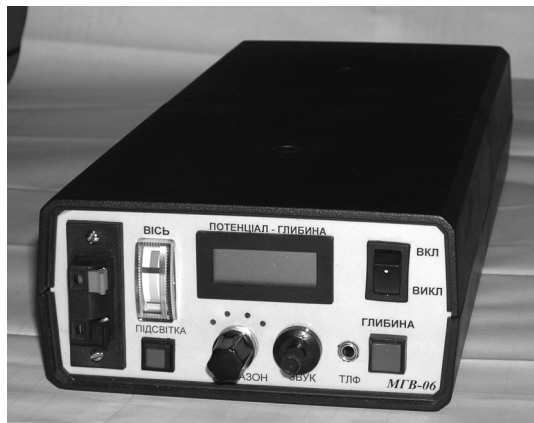
Рис. 7. МГВ для визначення місця, міряння глибини залягання ПТ та електричних потенціалів для контролю електрохімічного захисту
