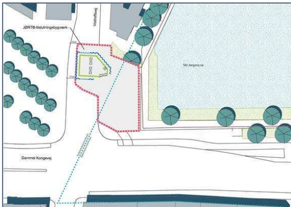
Afgrænsning af kommende byggeskakt ved Skt. Jørgens Sø , fase 1 (etablering af tilslutningsbygværk). Rød linje angiver den overordnede byggepladsafgrænsning i perioden.
