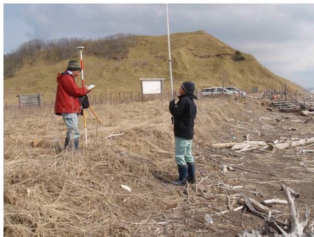
写真1 津波高および遡上距離測量の様子
