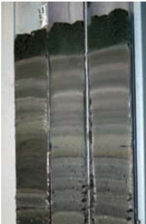
Oben: Mit dem Sedimentstecher werden Sedimentkerne aus dem Seegrund geholt.
