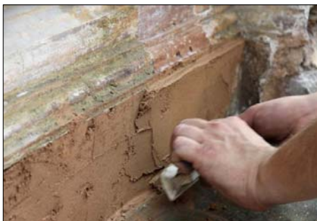
Obr. 8 Zkoušky malt z románského cementu
