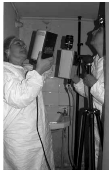
Fotos 57: Prospección con reflectografía IR en el cielo del baño 2 para la detección de inscripciones y marcas subyacentes (P. Monteverde, 2011).
