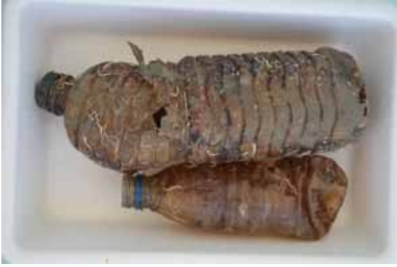
Üzerinde Teredo navalis kavkaları bulunan PET su şişeleri
