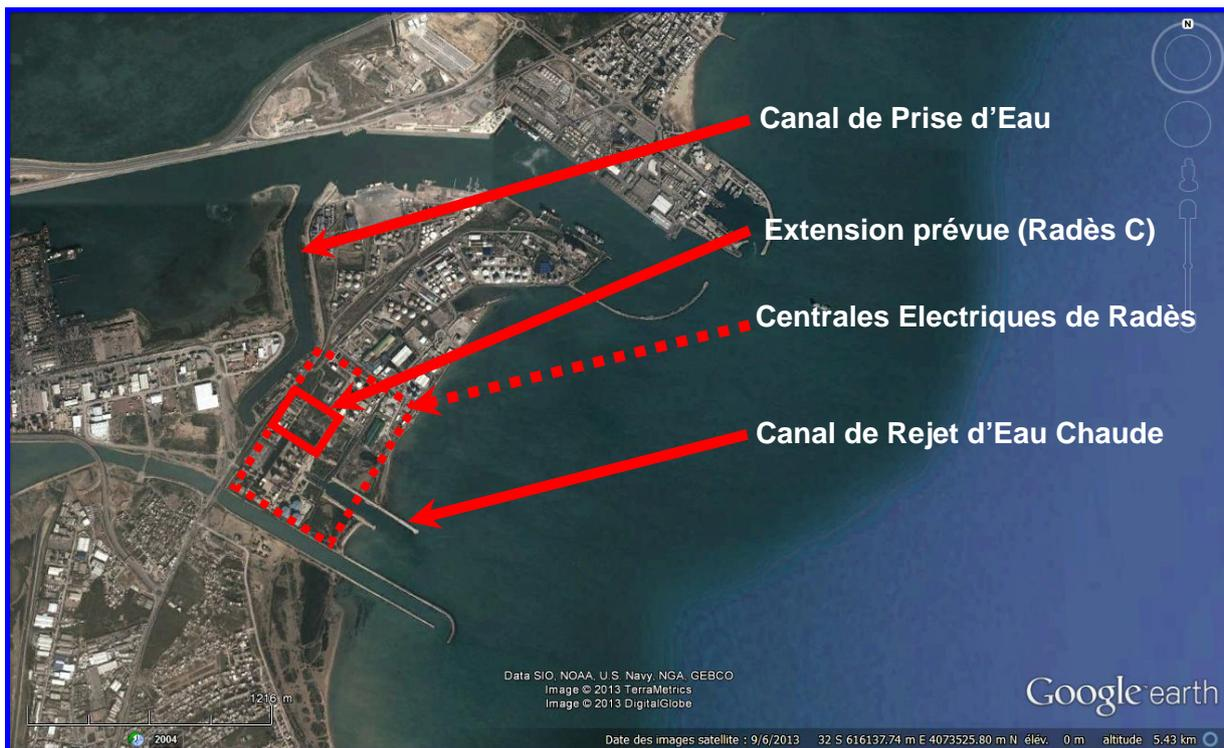
**Figure 50 : Localisation des centrales électriques de Radès.**
