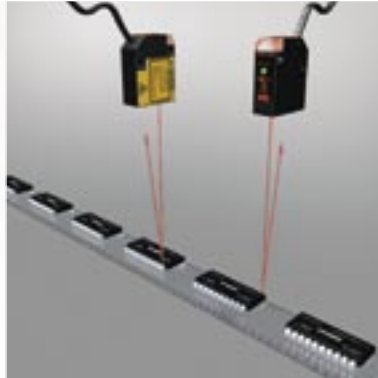
Inspección de patillas finas
