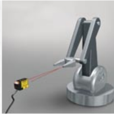
Aprendizaje de posición repetida de brazo de robot para calibración
