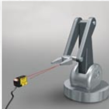
Gjentatt posisjoningslæring av robotarm for kalibrering
