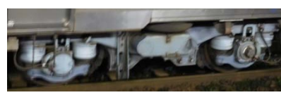
圖 14 EMU700 轉向架 攝於台中舊火車站
