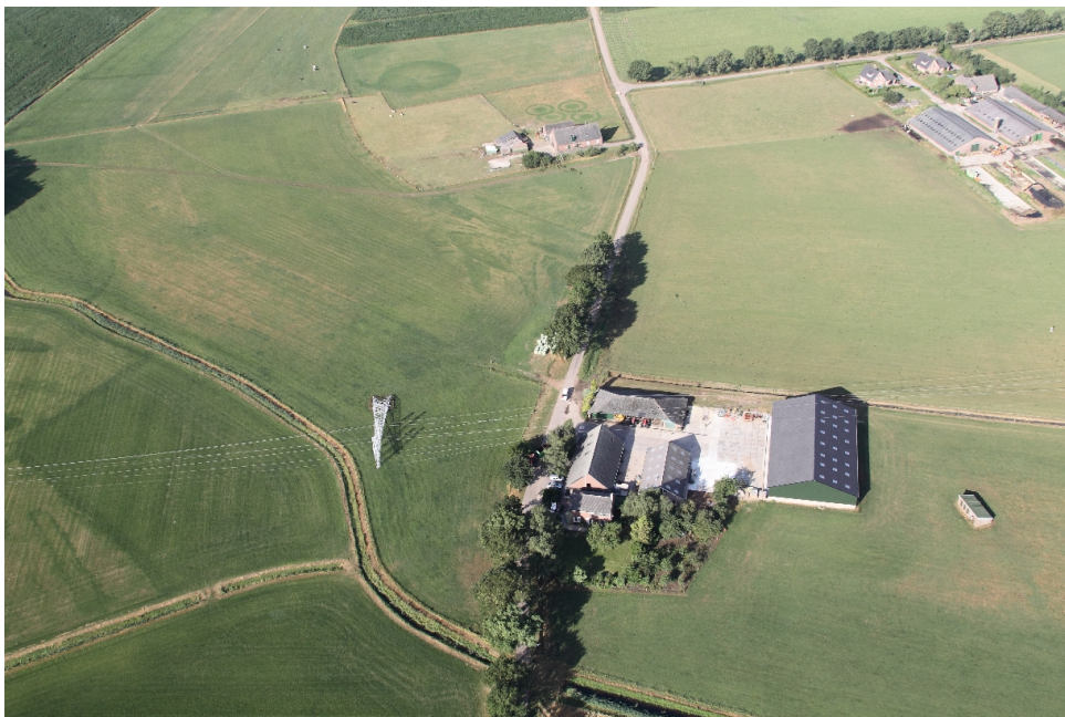
Figuur 7. Eén van de vijf omgevallen hoogspanningsmasten (Bron:KLPD)
