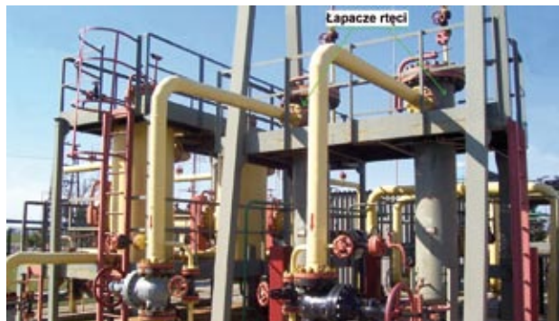
ŁAPACZE RTĘCI MAJĄ ZA ZADANIE ODEBRAĆ RTĘĆ W POSTACI KROPEŁ
