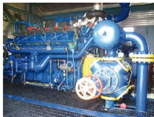
SILNIK TŁOCZNI GAZU TYPU WAUKESHA O MOCY 755 KW
