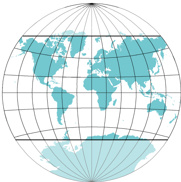
Abb. 3: In Weltatlanten werden die Polbereiche bei der Van der Grinten-I-Abbildung üblicherweise „abgeschnitten“ (Konstruiert mit dem Programm GEOCART® 3).
