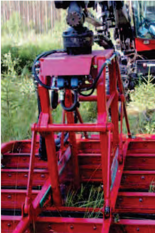
Naarva P55 kitkevä perkaaja nostaa vesat juurineen irti maasta puristettuaan ne ensin leuoilla kumien väliin.
