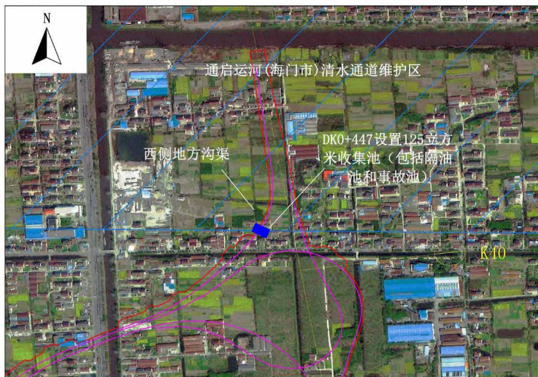
图6.2-4 通启运河（海门市）清水通道区桥面径流收集池（天补枢纽D匝道）
