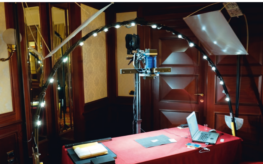
Sistema MSI di MegaVision con tecnologia RTI © MegaVision
