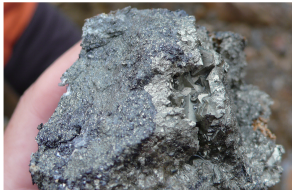
圖3 黃金瀑布河床上所採集礦石可見晶形良好的黃鐵礦與黑色的硫砷銅礦, 這些硫化礦物的風化是造成酸性礦山排水的主因。
