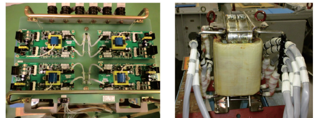
■ 図9 パワーユニット(インバータユニット)と高周波トランス Fig.9 Power unit (Inverter unit) and High-frequency transformer
