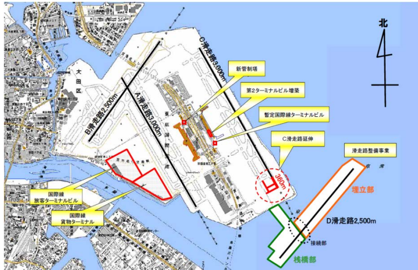
図 2-15 羽田空港再拡張事業・C滑走路延伸の概要
