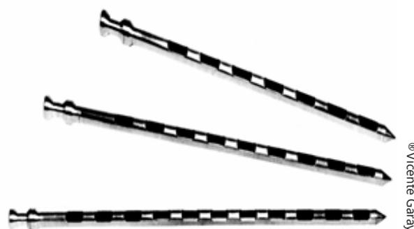
Figura 43. Sondas para la obtención de muestras de semillas pequeñas.
