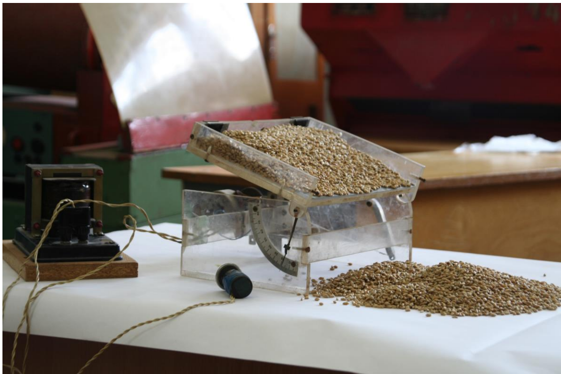
Рис.3.4. Прибор для определения углов внешнего и внутреннего трения: а – схема прибора; б – общий вид прибора
