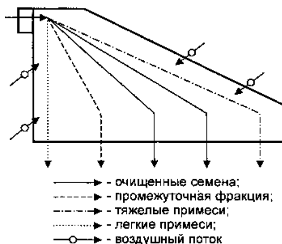
Рис. 1.13. Технологическая схема работы ПСС-1
