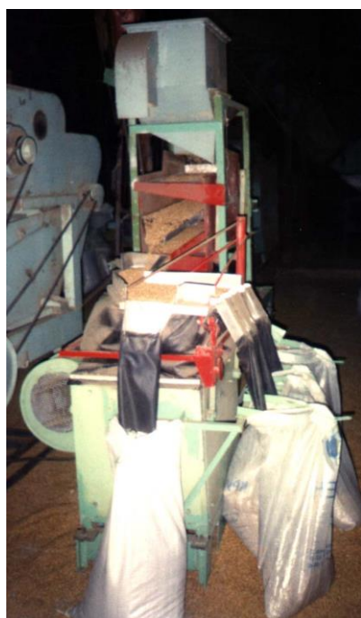
Рис. 3.9. Семеочистительная приставка (а), реализующая усовершенствованную фракционную схему очистки и сортирования семян (б):
