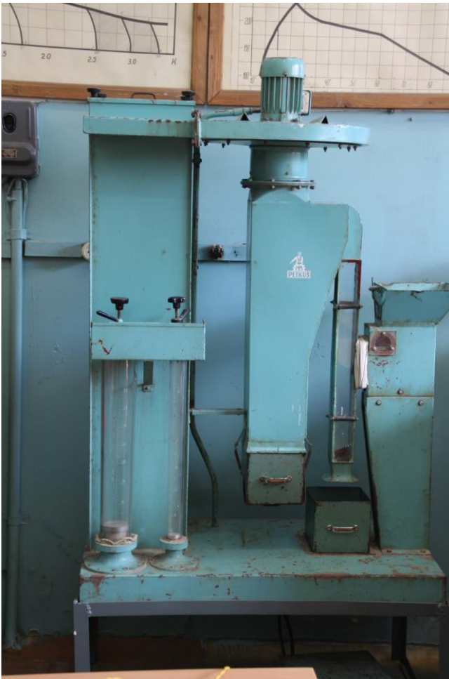
Рис. 3.3. Лабораторные машины: а – решетный классификатор; б – парусный классификатор фирмы «Petkus»
