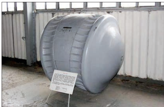
■ Загадочный Kugelpanzer («Бронированный шарик») из Кубинки. Узкая смотровая щель спереди, водительский люк над стойкой заднего катка — и всё...
