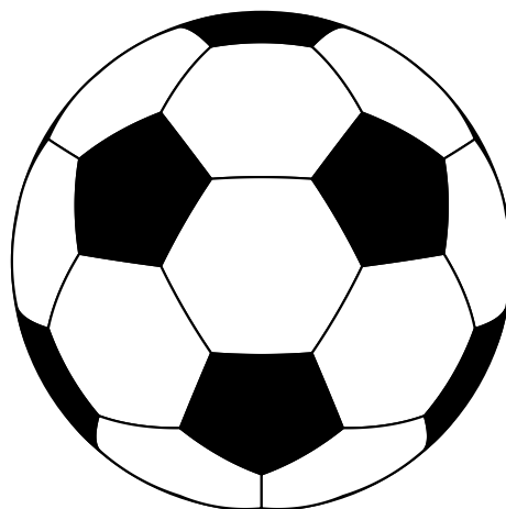
FIGURA 16: Il pallone da calcio ottenuto mediante proiezione centrale su una sfera di un icosaedro troncato.
