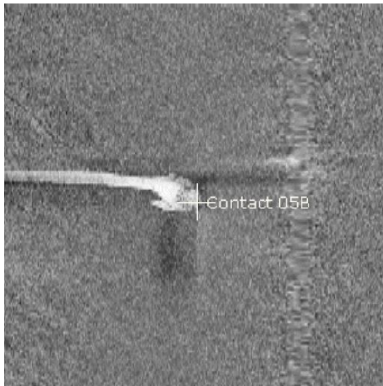
Gambar 50 Tanda kontak sonar pada sebuah mosaik citra SSS (AKSLI, 2015)
