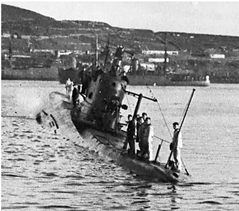
Подлодка «Л-17» после всплытия. Учения АСО (ЭПРОН) ТОФ по подъему подлодки «Л-17». о-в Русский, 11 июля 1942 г.
