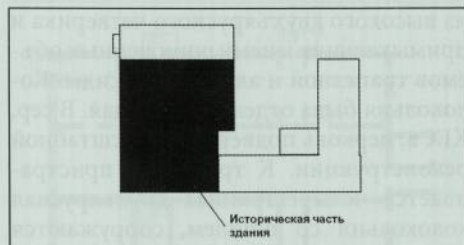
Расположение здания-памятника в исторически сложившемся объеме строения.
