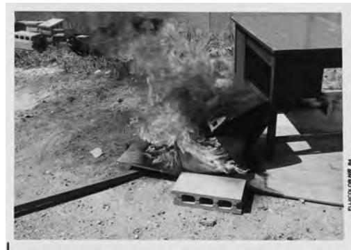
ストーブの燃焼実験の様子
