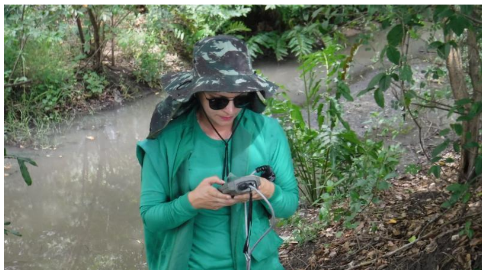
Figura 16. Averiguação dos parâmetros com o medidor Hanna HI 9829 conectado a sonda de multiparâmetros.
