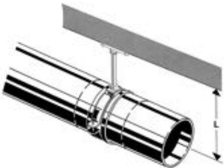
Abbildung 565: Fixpunkt mit Geberit PE Doppelbundbüchse Art.-Nr. 37X.751.16.1
