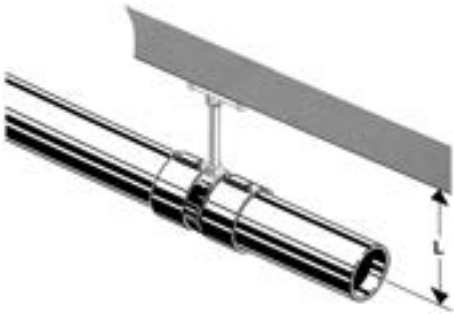
Abbildung 563: Fixpunkt mit zwei Geberit Elektroschweißmuffen Art.-Nr. 36X.771.16.1 oder zwei Geberit PE Thermomuffen Art.-Nr. 37X.775.16.1
