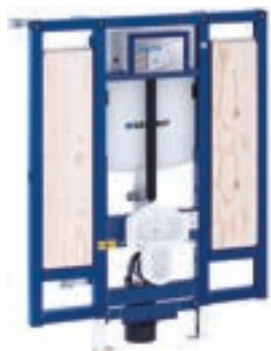
Abbildung 154: Geberit Duofix Element für Wand-WC, 112 cm, mit Sigma UP-Spülkasten 12 cm, barrierefrei, WC höhenverstellbar, für Stütz- und Haltegriffe
