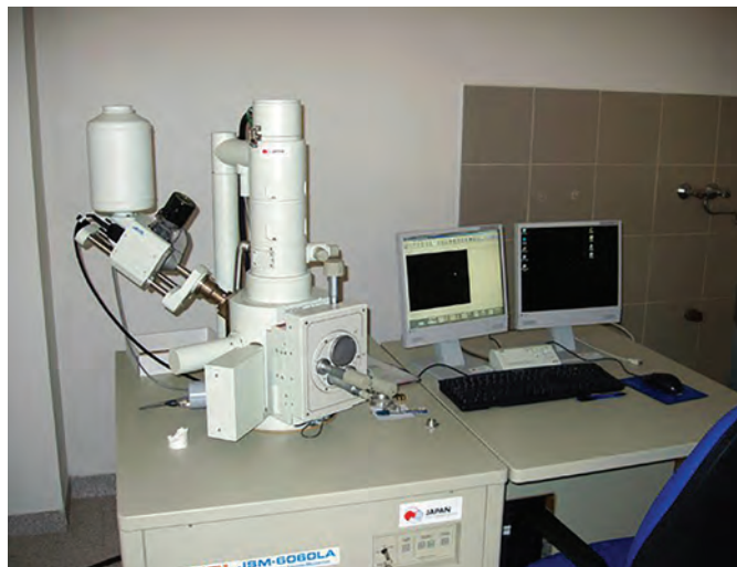
7. Skenovací elektrónový mikroskop Jeol 6060LA s energo-disperzným spektrometrickým analyzátorom EX-23000BU (SEM-EDS). Foto: Archív CHTO PÚ SR.
