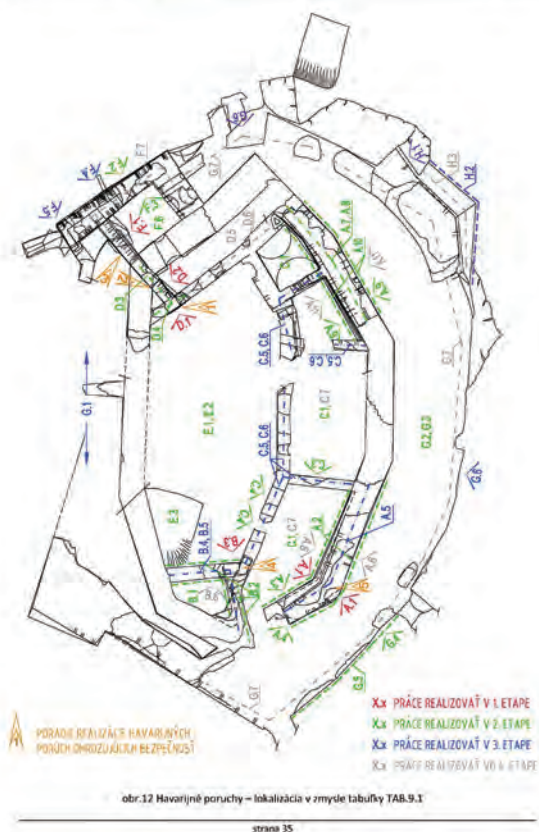
4. Statický pasport hradov Turňa a Divín. Príklad grafického a textového vyhodnotenia pasportu. Zdroj: KYSELOVÁ, Katarína. Pasport zrúcaniny NKP Turnianskeho hradu Turňa nad Bodvou. Stanislav KYSEL, s. r. o., 2016. KOHÚT, Vladimír – KYSELOVÁ, Katarína. Pasport zrúcaniny. NKP hrad Divín, časť horný hrad a parkán. Prodis plus s. r. o., 2012.
