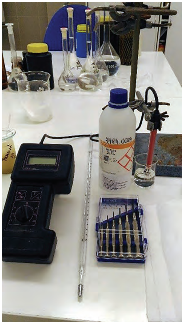
10. Konduktometer na meranie mernej elektrickej vodivosti. Foto: Lenka Dubinyová, 2018. Zdroj: Archív CHTO PÚ SR.
