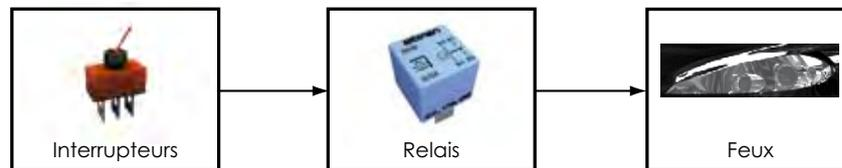
La centrale à relais s'est informatisée et est devenue une unité de contrôle de feux pouvant incorporer un contrôle de lampes grillées et servant d'interface pour l'allumage automatique des feux et un asservissement de la hauteur des phares.
