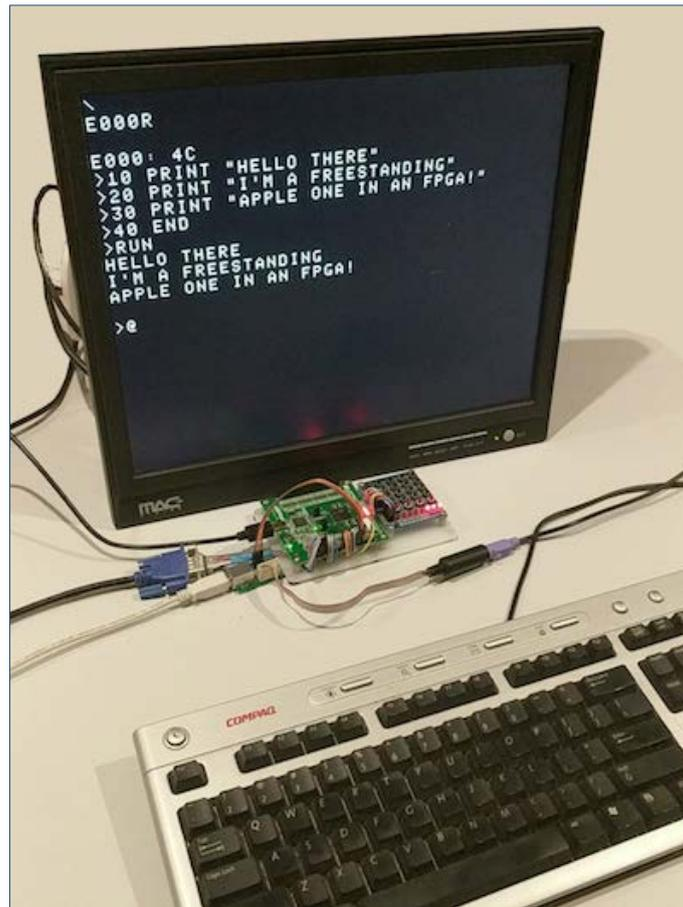
*Ilustración 3: Emulación de Apple I en FPGA (Alangarf) (Garfield, Moseley, & Otros, 2018)*
