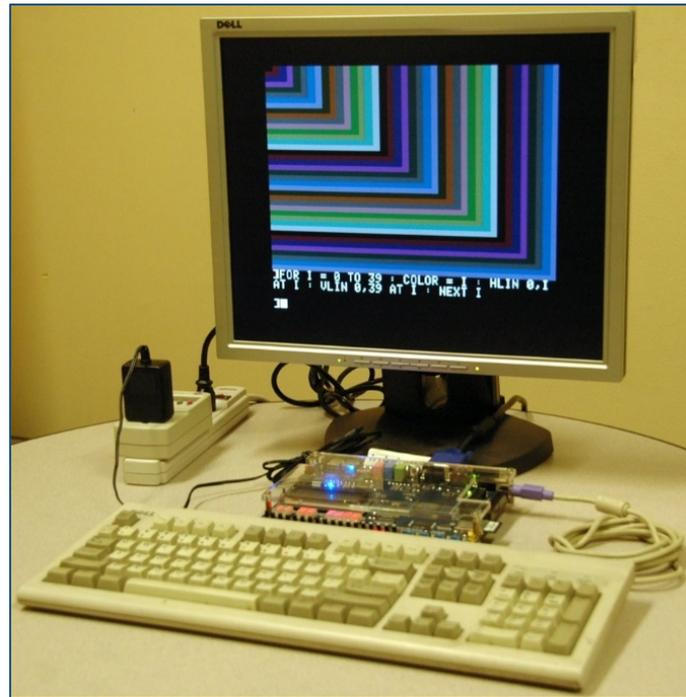
Ilustración 7: Emulación del Apple II en una placa FPGA (Edwards, 2007)
