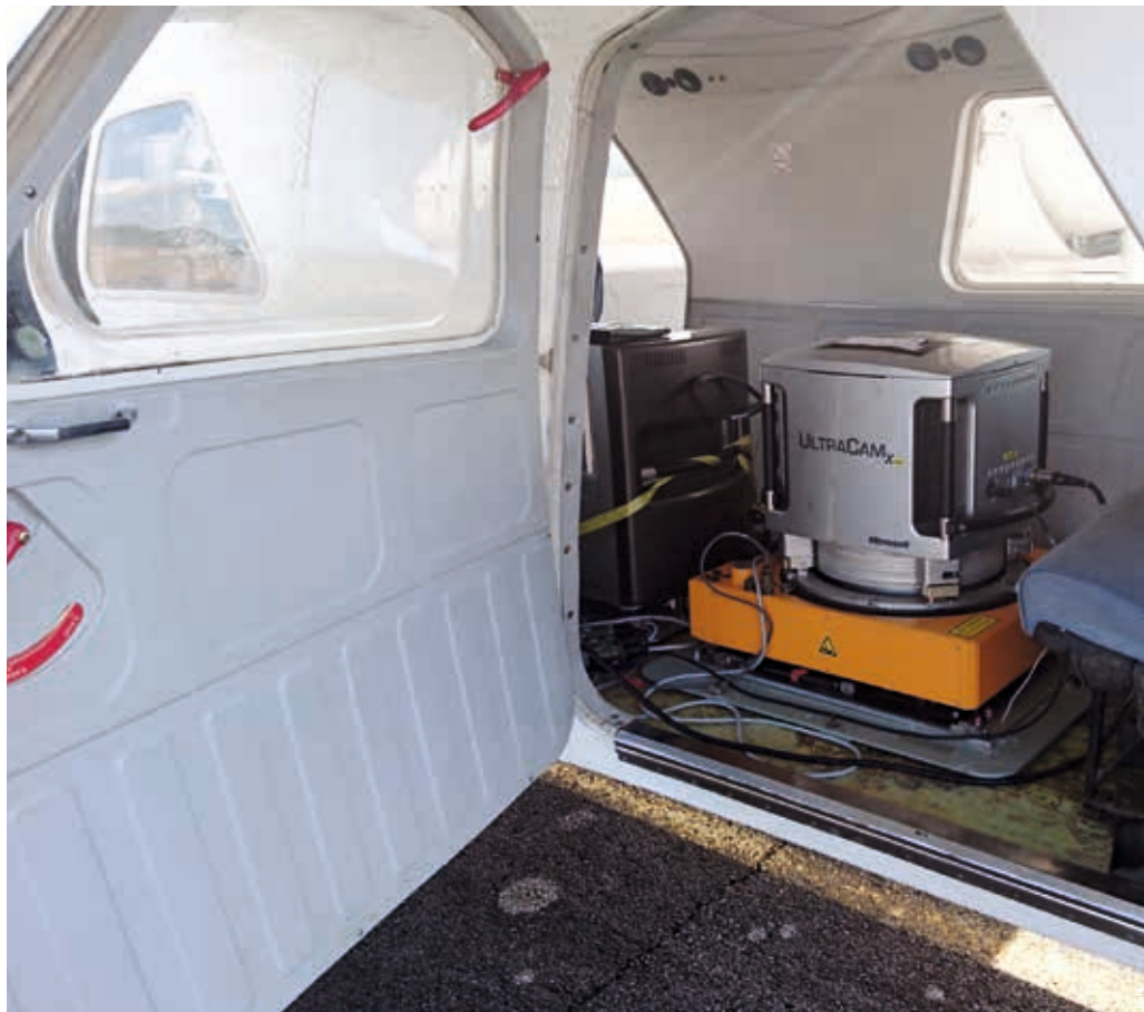
Caméra Aérodata montée sur sa plateforme gyrostabilisée dans l'avion ALTOA.
