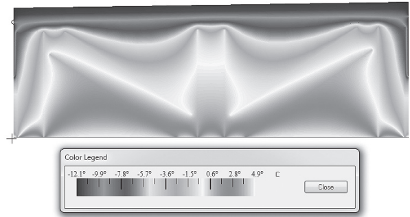
Рис. 2. Теплове поле експериментального вузла
