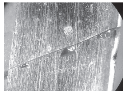
Рис. 12. Взаємоперехідні подряпини на виробах зі скла
