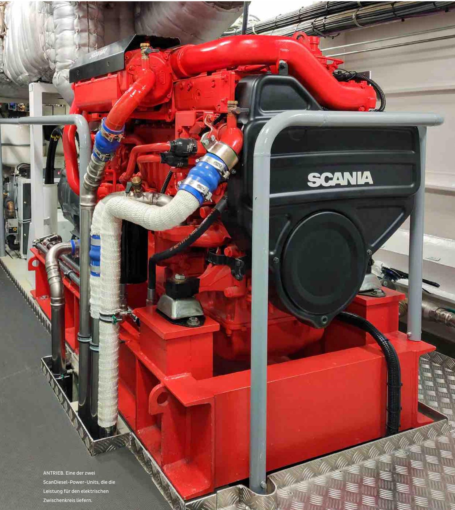
ANTRIEB. Eine der zwei ScanDiesel-Power-Units, die die Leistung für den elektrischen Zwischenkreis liefern.
