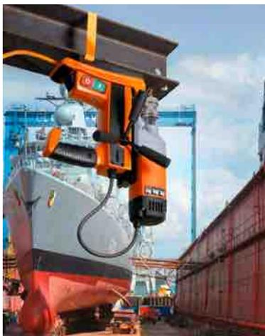
**MULTITALENT.** Die Alfra-Metallkernbohrmaschine mit Magnetsockel bohrt in jeder Lage sicher.
