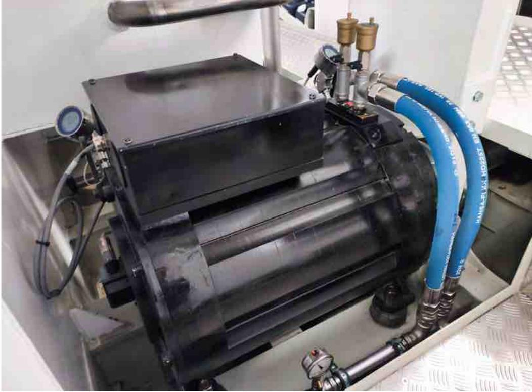
**AUSSTATTUNG.** Einer der zwei elektrischen Fahrtriebe vom Typ Baumüller DST2, die aus dem Zwischenkreis gespeist werden und direkt die Propeller antreiben.
