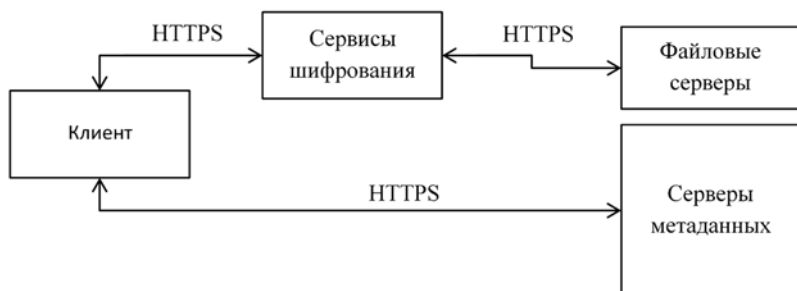
Рис. 2. Модель криптографического преобразования сервисами облачного хранилища
