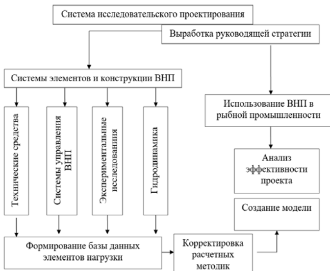
Рис. 1. Блок-схема системы исследовательского проектирования вспомогательного несамоходного плавсредства
