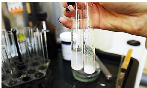
Рис. 1. Сравнение растворимости аспирина в воде (слева) и в этаноле (справа)
