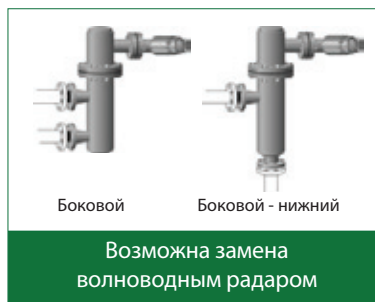
Рис. 1. Тип/форма камеры буйкового уровнемера.
