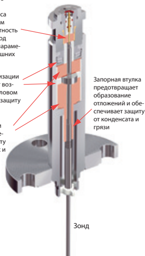
Рис. 5. Конструкция зондов исполнения НТНР/НР.
