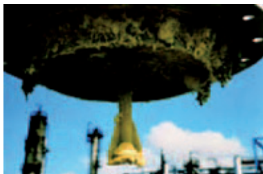
Рис. 2. Уровнемер Rosemount с параболической антенной, покрытой отложениями серы
