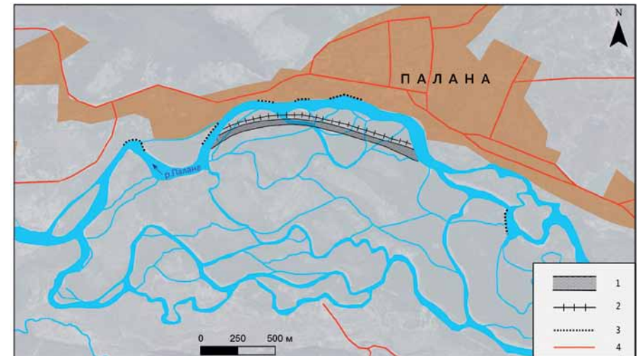
Рис. 3.50. Проектная схема канала спрямления русла р. Паланы (на основе чертежа ДВНИИВХ 1017-ГР, лист 2 [Расчистка и спрямление..., 2007])
