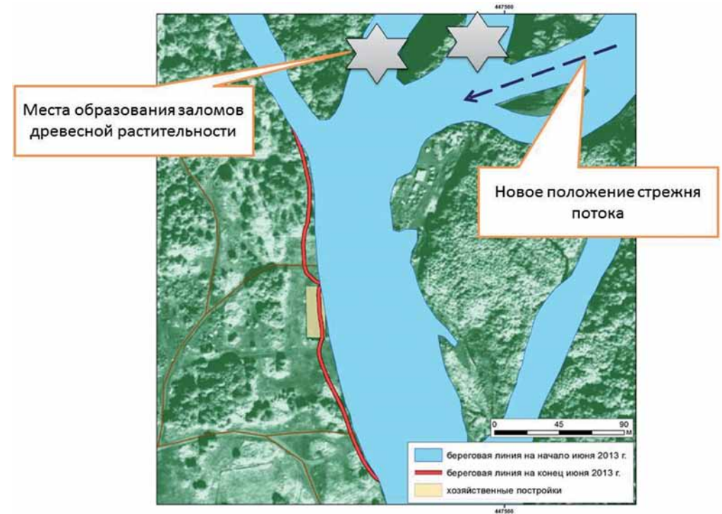
Рис. 3.64. Схема переформирования русла в северной части посёлка Северные Коряки в июне 2013 г.
