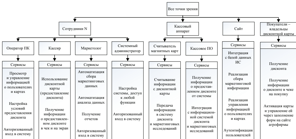
Рис. 50. Акторы, соотнесенные с возможными сервисами системы
